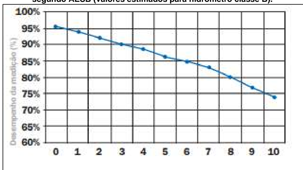
Figura 37: Desempenho da medição em função do tempo de instalação dos hidrômetros, segundo AESB (valores estimados para hidrômetro classe B).
