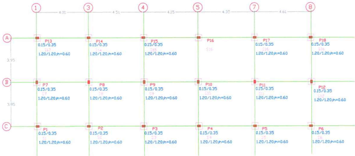
PLANTA DE LOCAÇÃO, SAPATAS E PILARES
