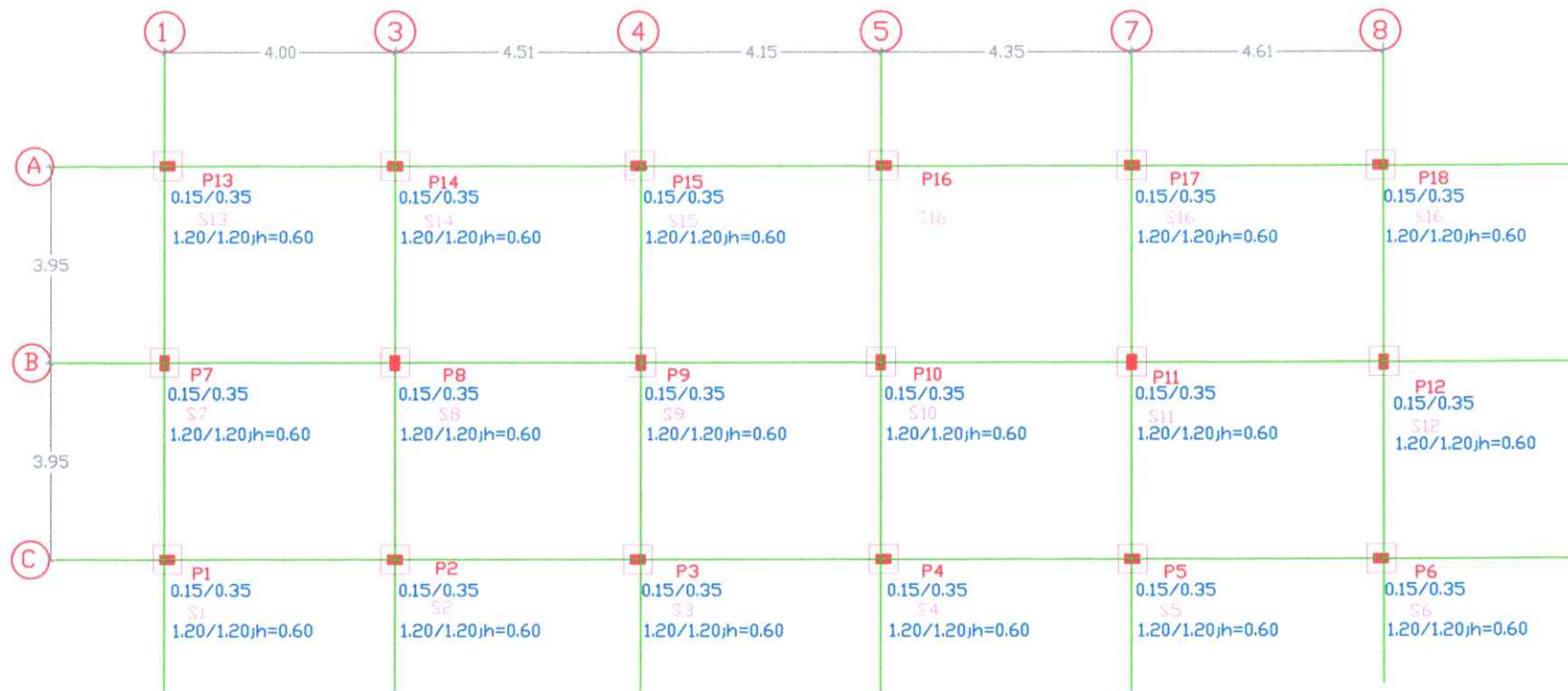
PLANTA DE LOCAÇÃO, SAPATAS E PILARES
